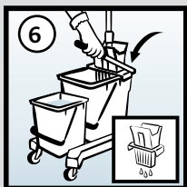
6 Поместить держатель с мопом в отжим и надавить на рычаг (повторение шага 3)
